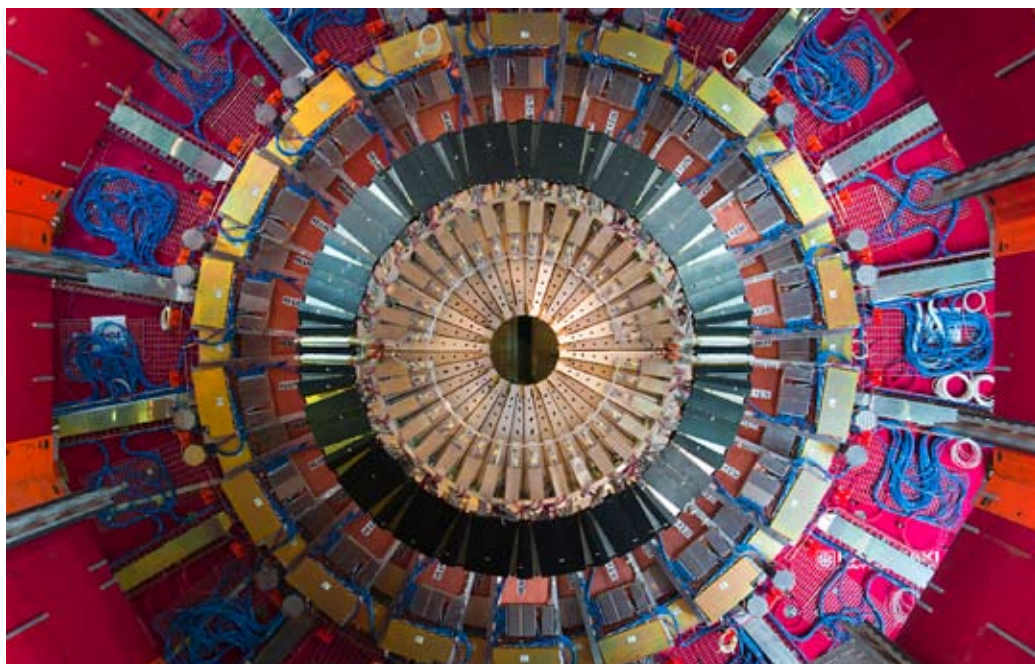
Ansicht des CMS Hadron Endkappen Kalorimeters umgeben vom Barrel Myon Systems während des Zusammenbaus in der Konstruktionshalle des CMS Experiments am Punkt 5 des LHC (CERN, Genf). (Bild zVg)
